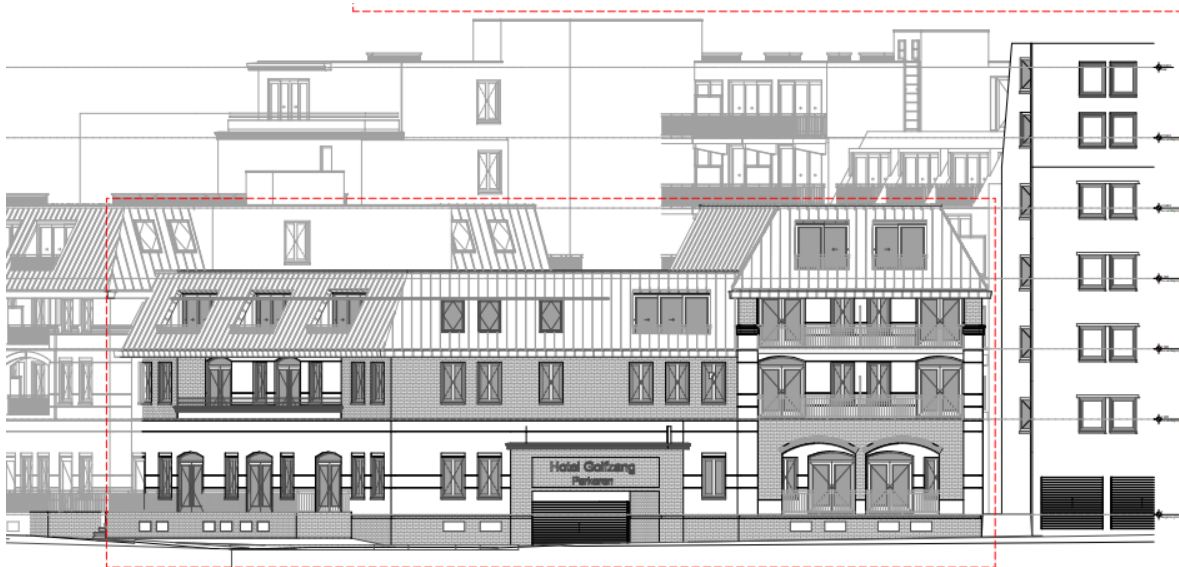
Afbeelding 20. Gevel fase II met entree parkeren Hotel Golfzang
